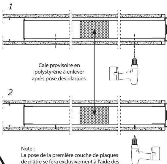
Cale provisoire en polystyrène à enlever après pose des plaques.
