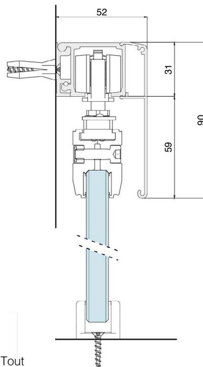
K751 est un kit complet pour la pose en applique d'une porte coulissante Tout Verre 10 mm. Le cache-rail est en finition aluminium. Possibilité d'installer un Soft close pour une ouverture et une fermeture tout en douceur.
