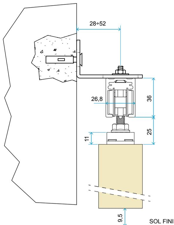
Basic est un kit économique pour la pose en applique d'une porte coulissante. Il ne contient ni cache-rail, ni montant de butée et permet donc d'en personnaliser la finition. Les pattes et étriers conviennent à la fixation au mur d'une porte d'épaisseur 34 ou 40 mm.
