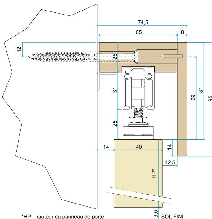
A2 est un kit complet pour la pose en applique d'une porte coulissante en bois. Le cache-rail et le montant de butée sont composés de bois brut à peindre. ce kit existe en deux versions : A2-A (sans montant de butée) et A2-B (avec montant de butée).
