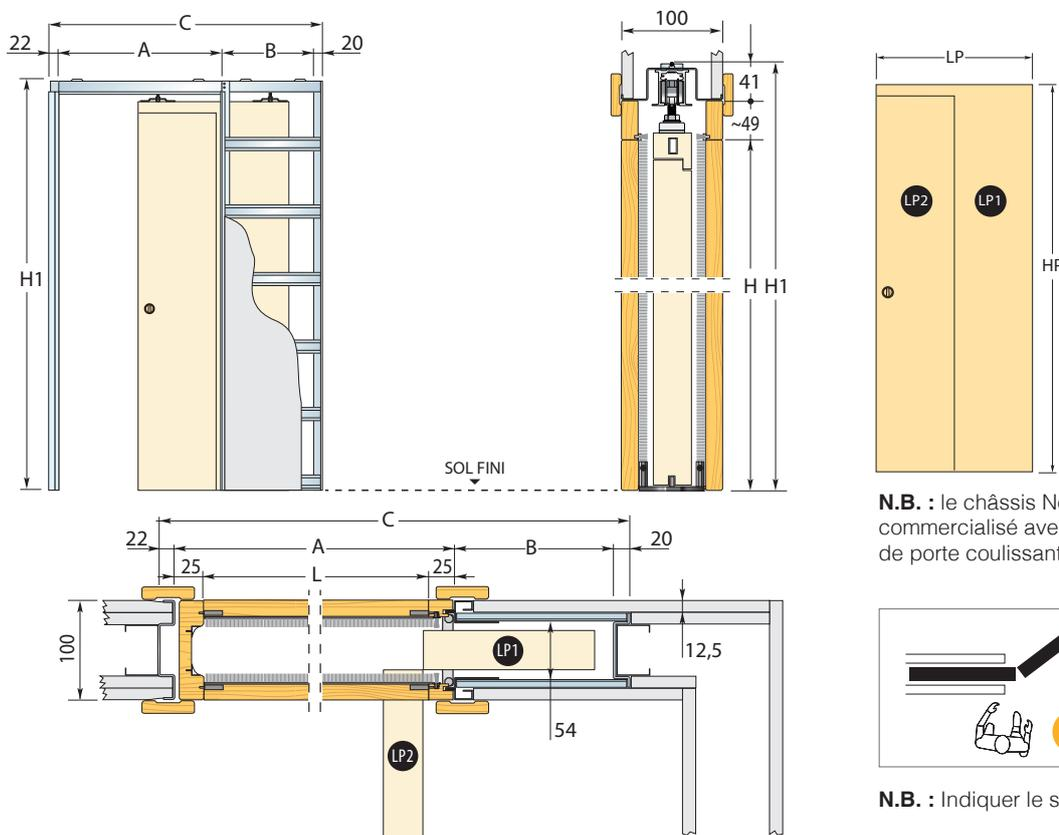
**N.B. :** le châssis Novanta est commercialisé avec un panneau de porte coulissant et battant
