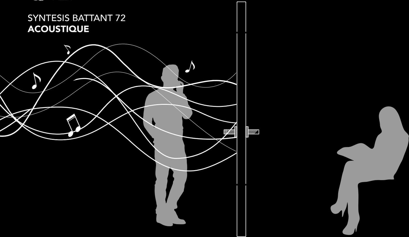
L'isolation au bruit est une caractéristique importante pour préserver sa tranquillité. Syntesis Battant est doté d'une porte âme pleine, d'une plinthe automatique en rainure basse de la porte et de joints isophoniques qui garantissent un bon affaiblissement acoustique.
