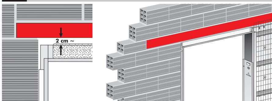
Il est nécessaire d'insérer un linteau et de laisser une lumière d'1 à 2 cm entre le linteau et la porte rail.
