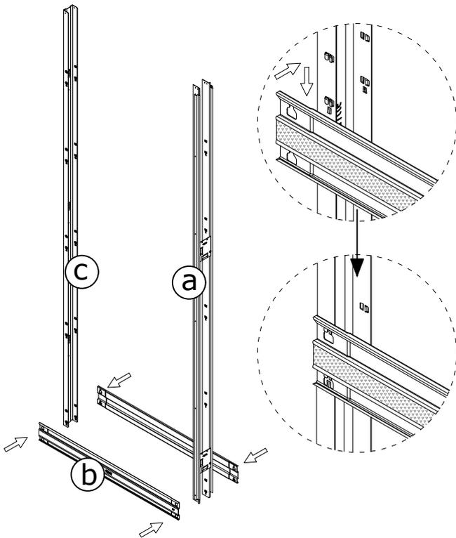
PHASE 3: Poursuivre l'assemblage des omégas (**b**) aux montants (**a**) et (**c**) sur les deux faces du châssis.
