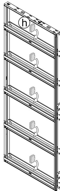
PHASE 6: Insérer le rail équipé du porte-rail en acier (e) dans la partie coffre (d) et pousser à fond jusqu'au déclic d'accrochage.
