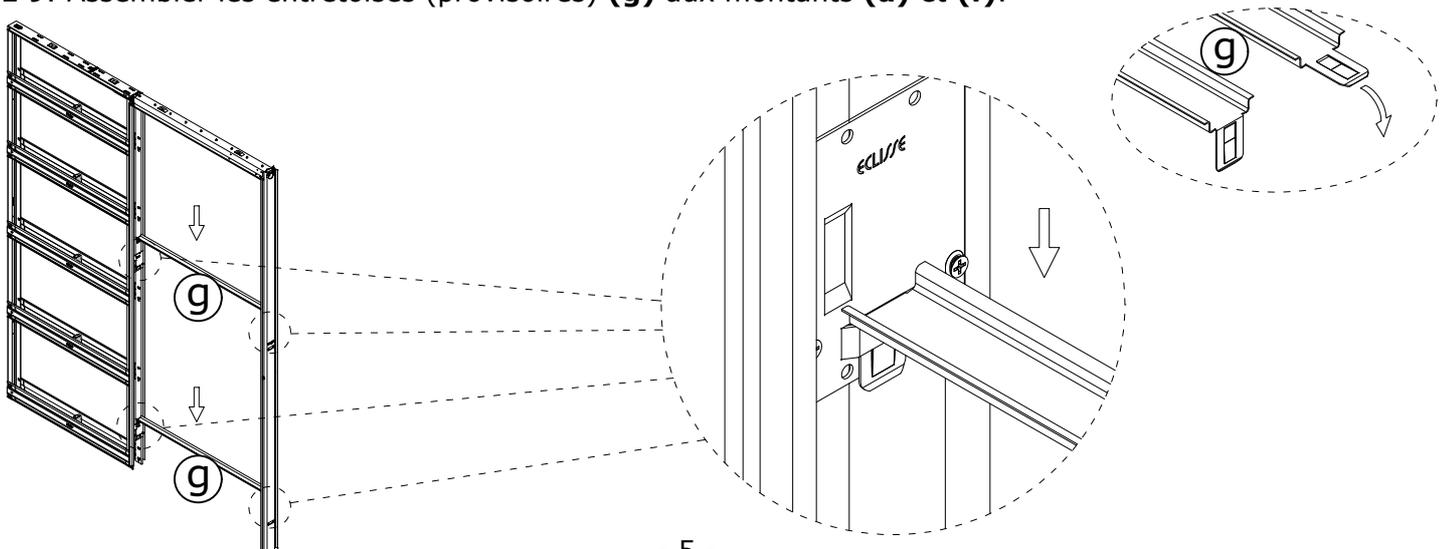
PHASE 10: Fixer le châssis assemblé à la cloison en vérifiant l'aplomb.
