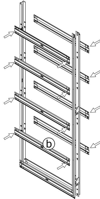
PHASE 4: Visser le porte-rail (d) aux montants (**a**) et (**c**) du coffre grâce aux vis fournies 4,2x9,5 mm du sachet (m).
