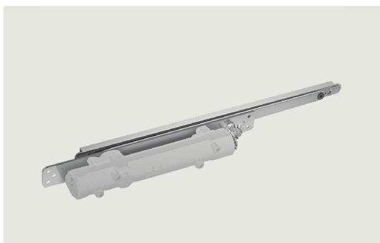
Grâce à sa construction compacte, le ferme-porte s'intègre dans la porte et son cadre. Seul son bras débrayé, résistant au feu et à la fumée, est visible de l'extérieur. Son concept permet de diminuer les efforts d'ouverture et de fermeture de la porte battante. La vitesse de fermeture est réglable par deux valves hydrauliques, même après son installation. Le système est réversible pour des portes droites ou gauches.
